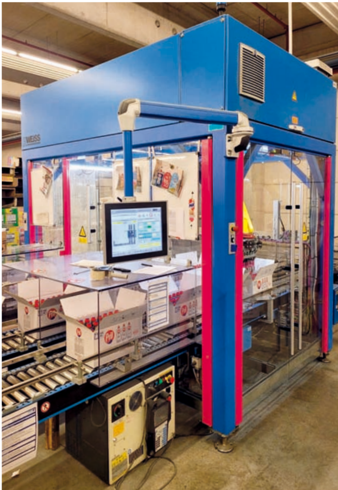
Zufuhr der ungemischten Waren in den Mischroboter
