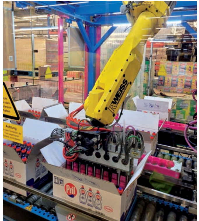
Sortierung der Mischkartons nach vorgegebenen Setzmuster durch den Mischroboter
