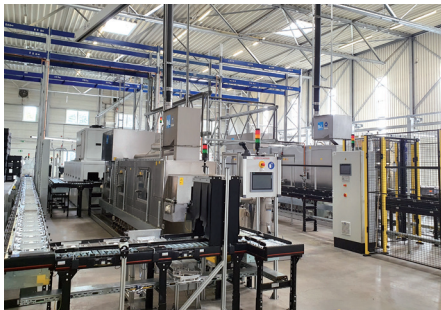
In unserer Industriewaschanlage werden Drehmomentwandler penibel gereinigt
