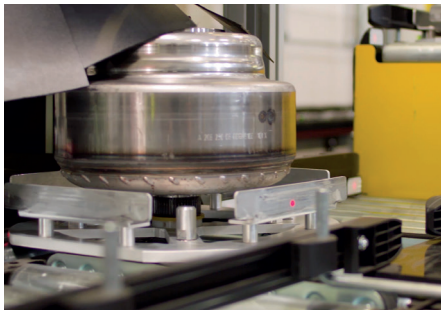
Jeder einzelne Wandler wird auf einem Objekträger exakt fixiert
